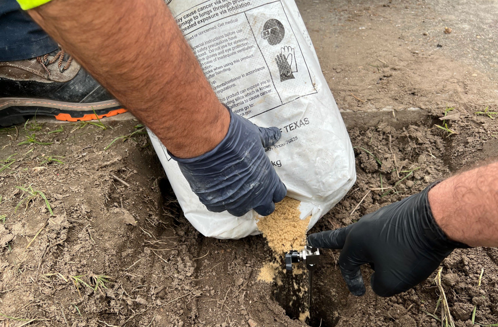
Instalación de sonda de gases atmosféricos – Liberty Rd
