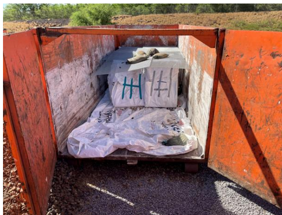
Figura 10. ¿Baterías en una piscina? (Foto de la IZQUIERDA). Las unidades de pared BESS/ESS recogidas de los incendios forestales de Maui se almacenan envueltas en Tyvek para minimizar la dispersión de cenizas tóxicas. Se coloca una malla metálica expandida encima y se lastra con sacos de arena para evitar la expulsión de celdas cilíndricas con energía, lo que podría provocar un incendio de la vegetación (foto de la DERECHA).
