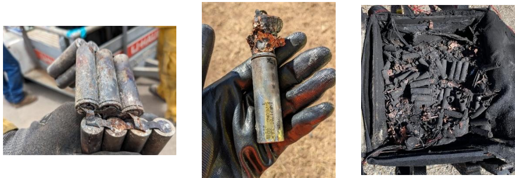
Figura 5. Ejemplos de celdas cilíndricas de LIB dañadas.
