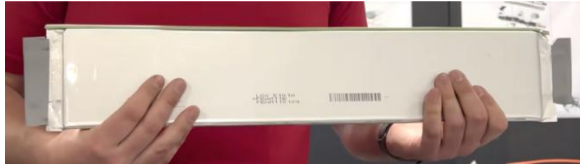
Figura 7. Ejemplos típicos de celdas tipo bolsa de LIB.
