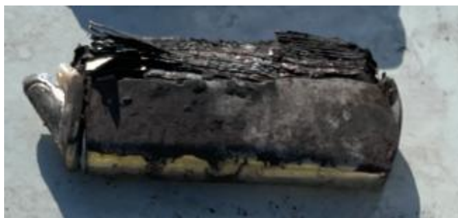
Figura 14. Producto final del desmantelamiento mediante aplastamiento.
