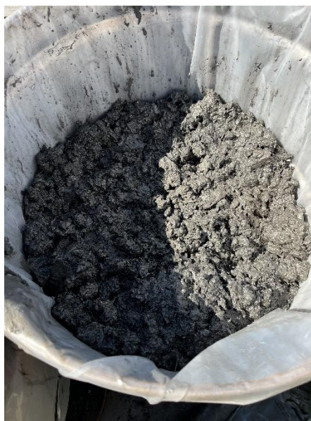
Figura 16. Producto final obtenido mediante trituración de baterías.
