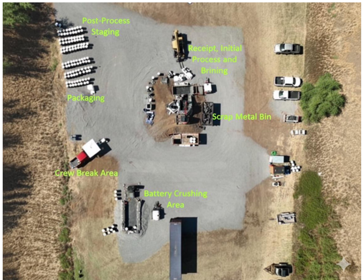
Figura 11. Vista aérea del área de desmontaje de baterías de iones de litio durante la respuesta a los incendios forestales de Maui de 2023.
