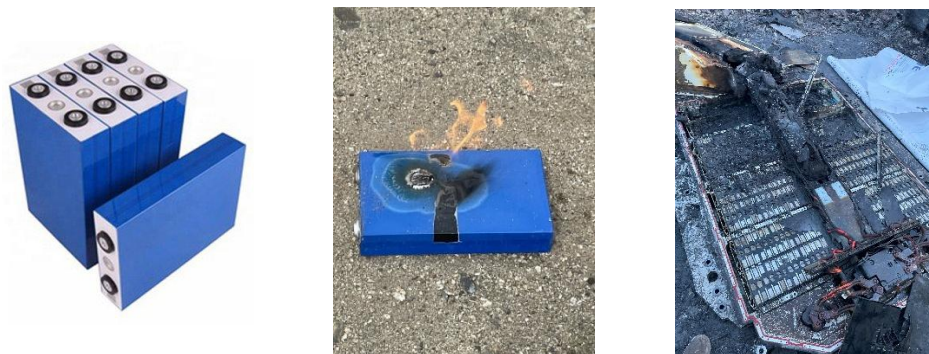
Figura 6. Ejemplo típico de una celda prismática de LIB (izquierda), una celda prismática en llamas (centro) y una estructura de batería de EV con celdas prismáticas dañadas, obtenida durante las tareas de respuesta a los incendios forestales del sur de California de 2025.
